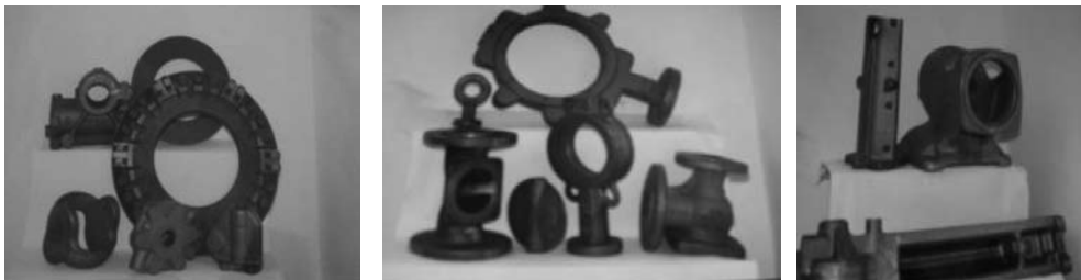
Exportöntvények (balra), pillangószelep-öntvények (középen) és szivattyúház-öntvények (jobbra)
